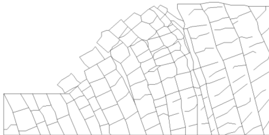
Рисунок 6.21 – Схема деформирования откоса, в котором может наблюдаться различная комбинация механизмов разрушения
